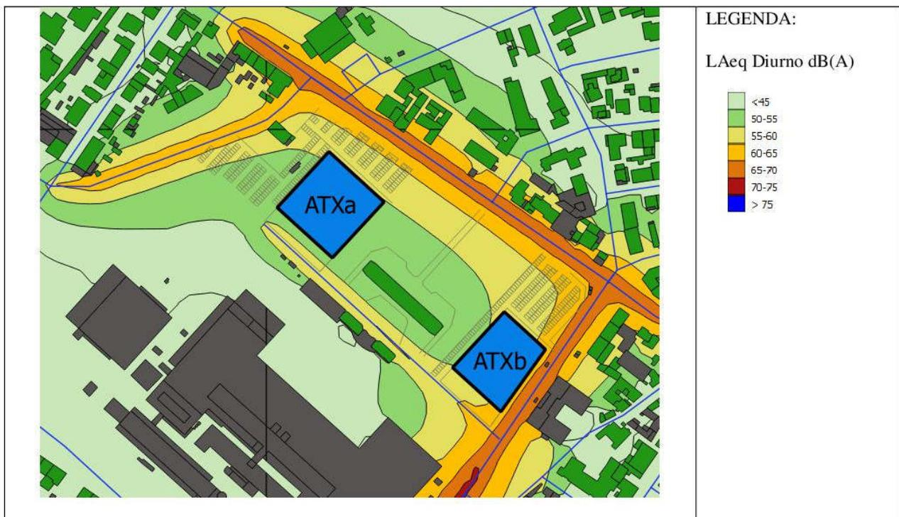
Figura 6 – Mappe isofoniche relative al modello di simulazione ante operam (periodo di riferimento diurno 06.00 - 22.00).
