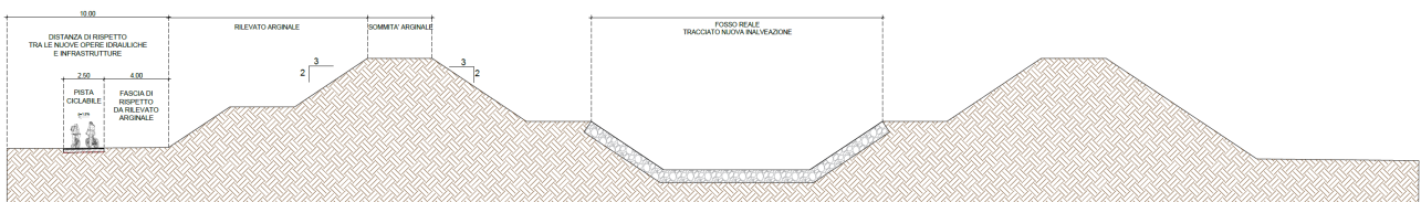
Asse ciclabile ovest: sezione tipo della pista ciclabile in affiancamento all'argine della nuova inalveazione del f. Reale
